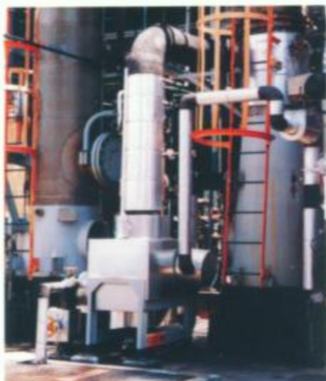
Компаблок как ребойлер десорбционной колонны этилацетата на заводе в Родиа, Бразилия
