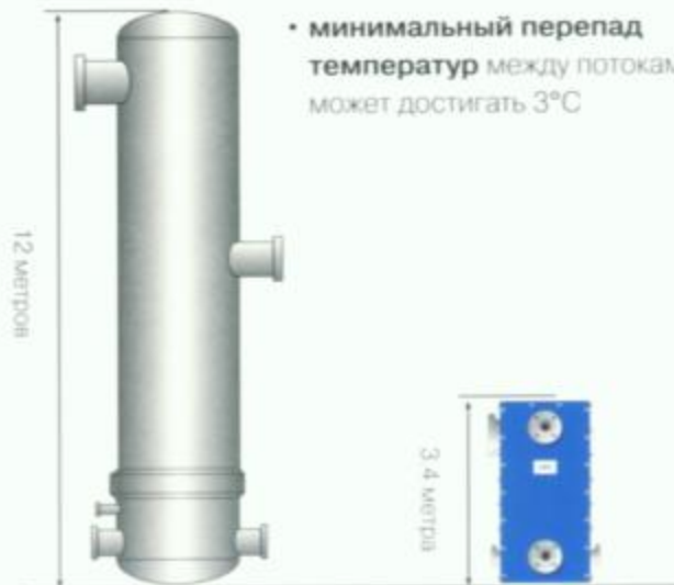
Компаблок в сравнении с кожухотрубным теплообменником
